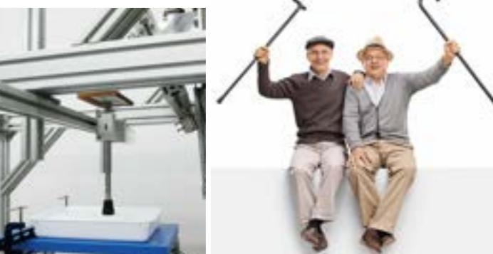
杖は高齢者や足を怪我した人たちにとって必要な補助具です。杖先には滑り止め用のゴムが付いていますが、北海道のような寒冷地では、冬季に杖先が滑ってしまい、転倒する事故は珍しくありません。冬道での転倒は骨折といった重傷になることもあります。そこで本学義肢装具学科では、「より滑りにくい杖先ゴム」の開発を目指し、氷上で杖先が滑る様子を調べる機械を作りました。なぜ、どういう状態だと杖先が滑るのか、そのメカニズムの解析を行っており、学生たちと一緒にいろいろな杖先ゴムの試作を通じて、新しい杖先ゴムの研究開発を行っています。
