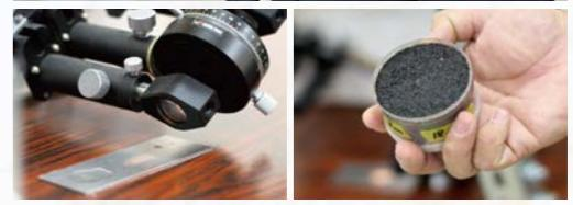
▲ 岩間先生は、さまざまな波形がある光を「縦に振動する波」と「横に振動する波」に分け、その2つが跳ね返る時の光の量を比較することで表面の荒さを調べているそう。表面が荒ければ荒いほど滑りにくいと言えます。
