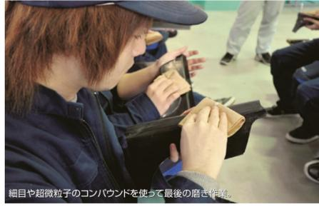
細目や超微粒子のコンパウンドを使って最後の磨き作業。
