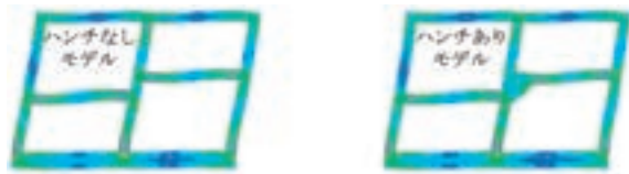
図9 FEM 解析値（段差1200：変形・応力図）
