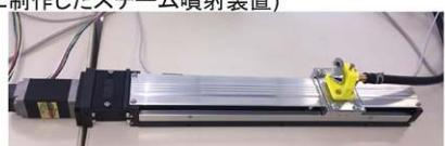
図5 スチーム噴射装置
